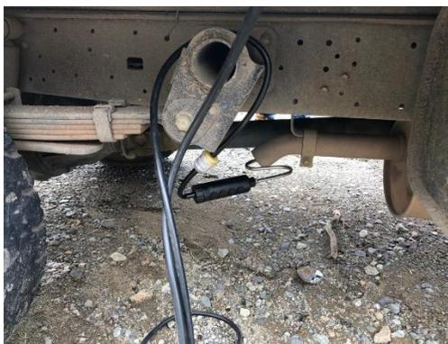
*Figura 15. Colocación de la sonda en tubo de escape. – Fuente: (Autores, 2021)*
