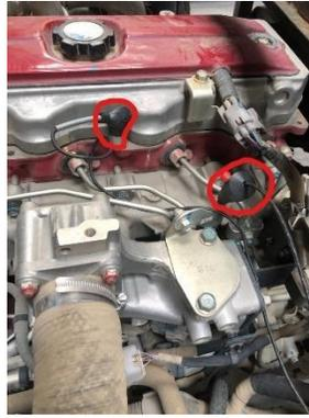
Figura 13. Conexión de cables del medidor de Rpm. - Fuente: (Autores, 2021)
