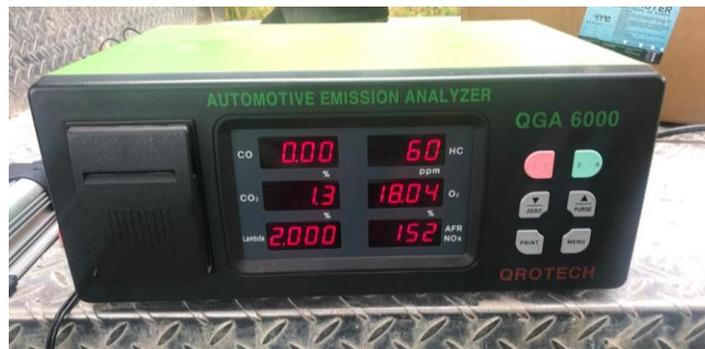
*Figura 12. Analizador de gases. - Fuente: (Autores, 2021)*
