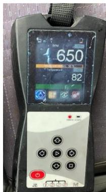
Figura 10. Medidor de rpm y Temperatura del aceite del motor. - Fuente: (Autores, 2021)
