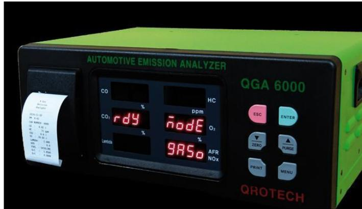
Figura 8. Analizador de gases - Fuente: (Arevalo & Ortega, 2016)
