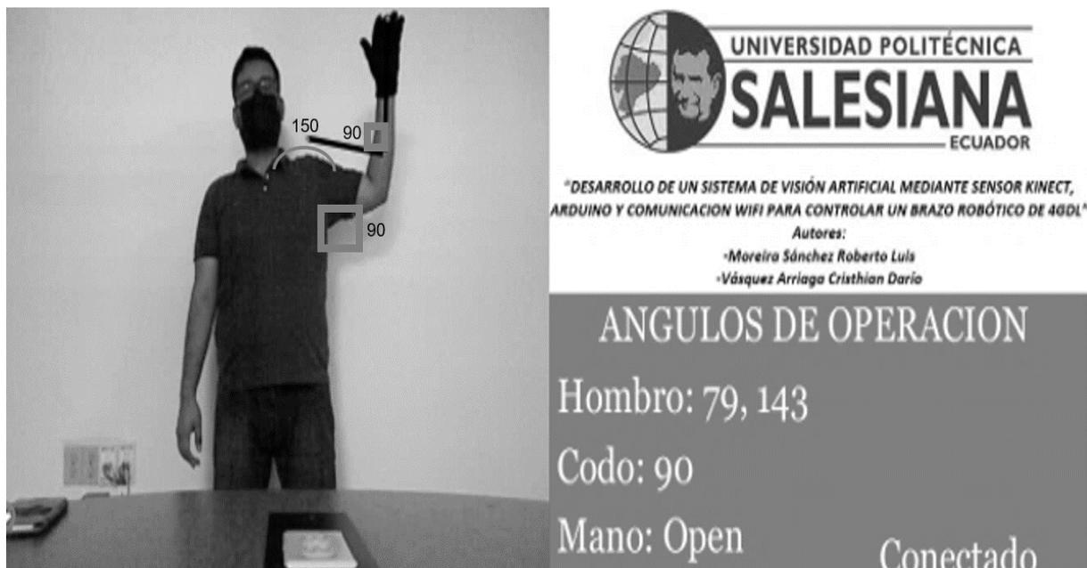
**Figura 98.** Comparativa de ángulos entre la realidad contra lo calculado después de realizar un movimiento.
