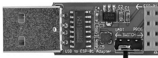
**Figura 10.** Adaptador USB a ESP8266 (UNIT ELECTRONIC, 2021).
