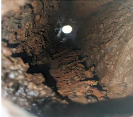
Figura 22. Presencia de incrustaciones al interior de la caldera.
