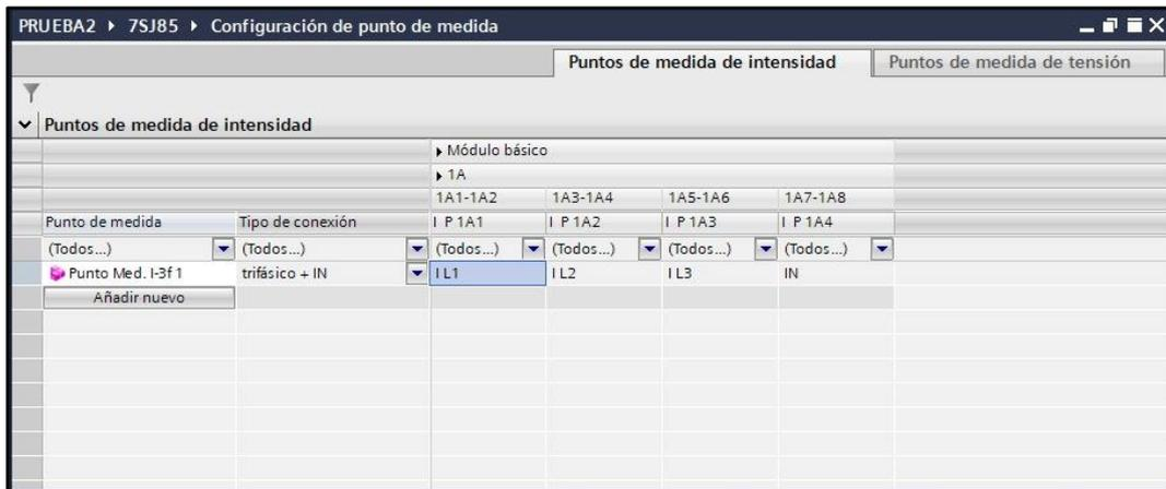
Figura 50. Configuración de puntos de medida para el relé 7SJ85 en DigiSi5.
