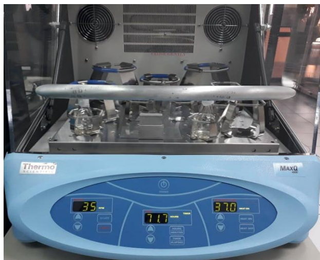
Figura 31. Incubación de las cepas puras en el medio mineral con PEBD durante el período de Adaptación.
