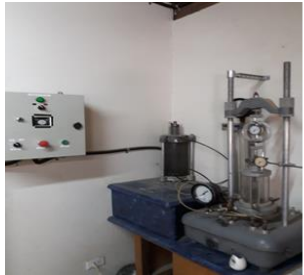
Figura 7. Equipo triaxial UU utilizado.
