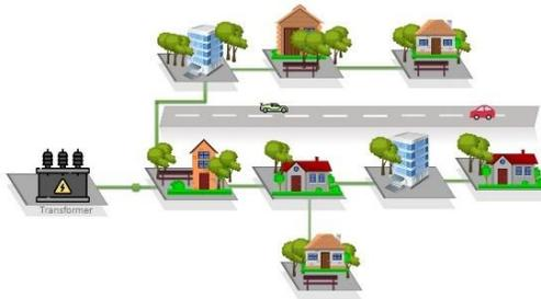
**Figura 1** Topología de un sistema radial.
