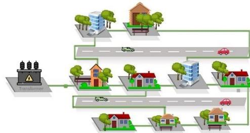
**Figura 3** Topología de un sistema mallado.
