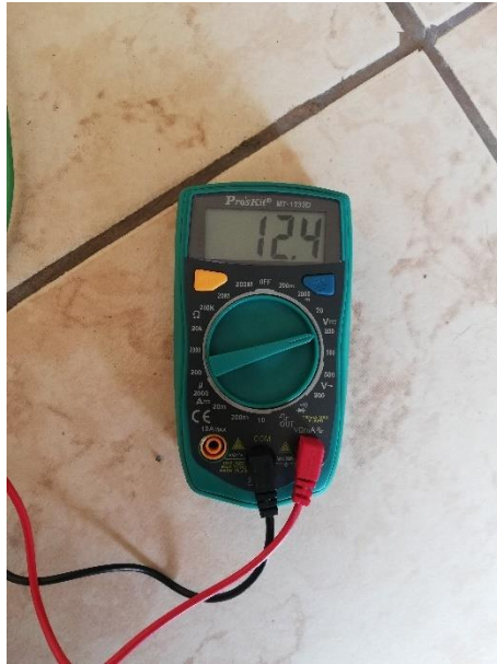
Anexo 10: Medición al ingreso del controlador de carga para control de carga y descarga de la batería a ser alimentada.
