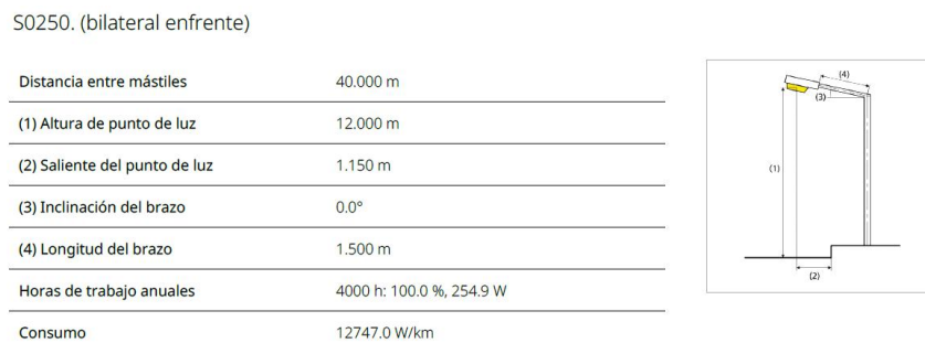
Figura 4.6: Características del trazado de la instalación
