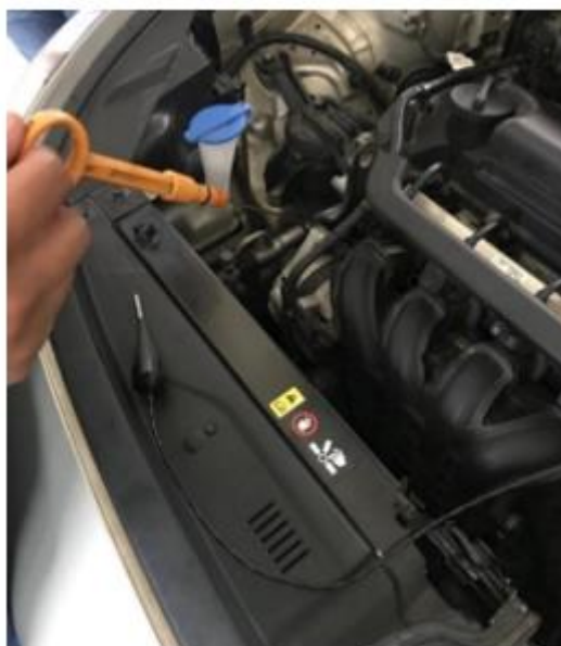
Figura B 6 Retiro de medidor de aceite.
