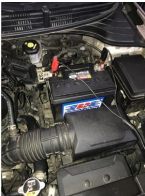
Figura B 5 Conexión de pinzas a bornes de batería.
