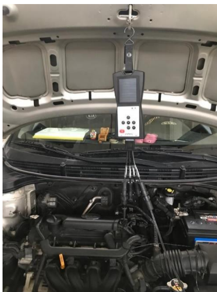
Figura B 4 Colocación de equipo MGT-300.
