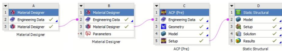
Figura 3.23. Esquema de proceso de simulación en Ansys Workbench
