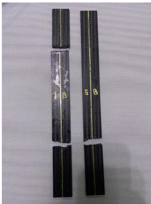
Figura 4.10. Tipo de fallo en Probeta 1B y 5B
