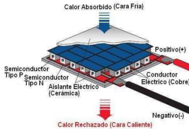
Figura 14.-Estructura interna de una celda de Peltier
