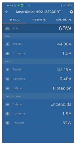
b) Voltajes y corrientes medidos por el controlador de carga
