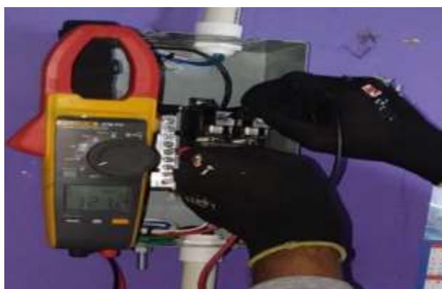
FIG. 54.3. MEDICIÓN DE VOLTAJE A VACÍO EN TERMINALES DE ALIMENTACIÓN AC, SE OBTIENE UN VOLTAJE DE 121,2V. (AUTOR)
