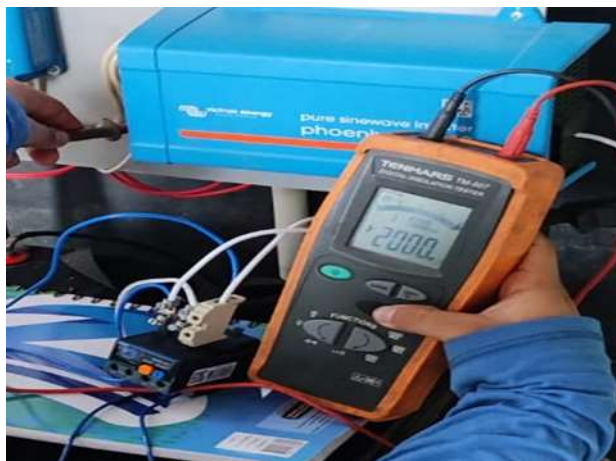
FIG. 60. EL VALOR ES DE 2000 MEGA OHMIOS, EL CUAL ES EL VALOR MÁS ALTO DE LA ESCALA DE NUESTRO INSTRUMENTO DE MEDICIÓN (AUTOR)
