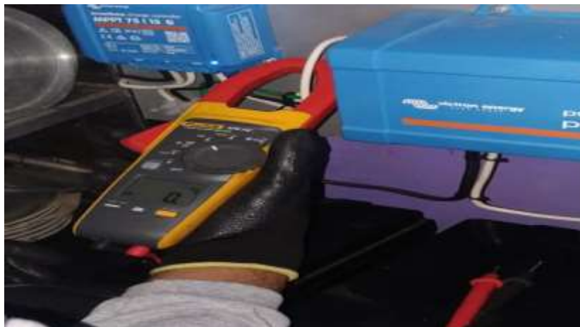
FIG. 54.1. MEDICIÓN DE CORRIENTE DE INVERSOR A VACÍO. (AUTOR)
