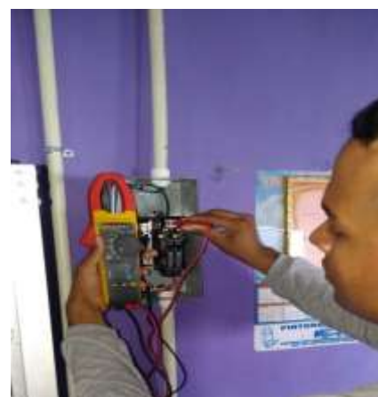
FIG. 55.1. LECTURA DE VOLTAJE A PLENA CARGA (AUTOR)
