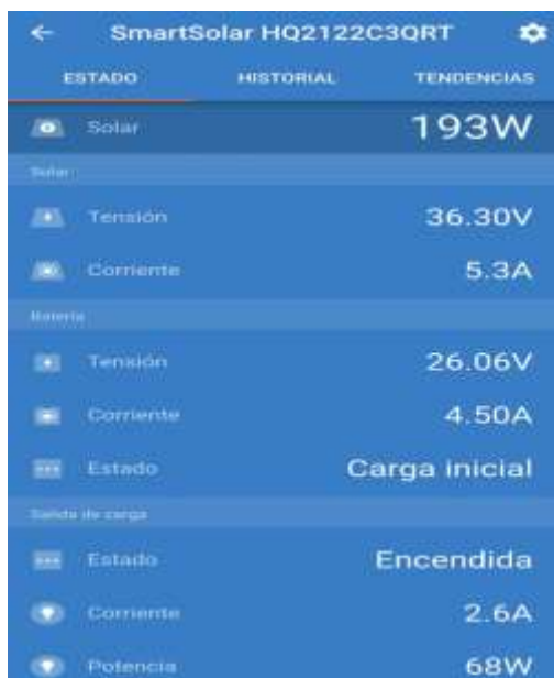
FIG. 56. LECTURA POR MEDIO DE LA APLICACIÓN VICTRON CONNECT (AUTOR)
