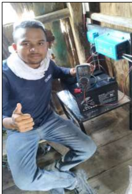
FIG. 72. COMPROBACIÓN DEL NIVEL DE TENSIÓN A LA SALIDA DEL INVERSOR (AUTOR)
