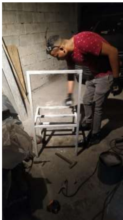
FIG. 64. PINTADO GENERAL DEL SOPORTE, DEL KIT FOTOVOLTAICO (AUTOR)
