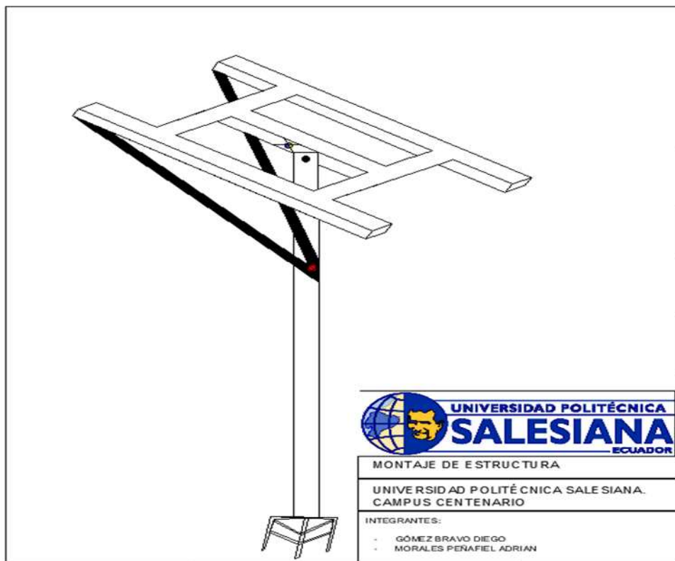
FIG. 52.1. ACOPLAMIENTO DE BASES DE SUJECIÓN DEL PANEL SOLAR (AUTOR)
