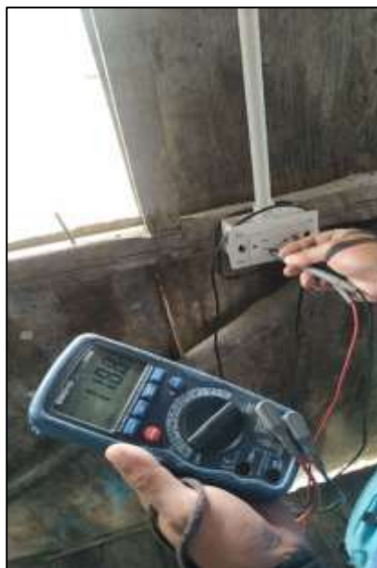
FIG. 73. COMPROBACIÓN DEL NIVEL DE TENSIÓN EN LA CAJA DE SERVICIO Y TOMACORRIENTES (AUTOR)
