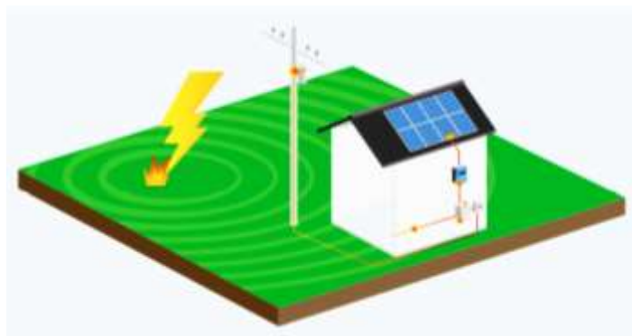
FIG. 22. DESCARGA ATMOSFÉRICA INDIRECTA (CLAMPER)
