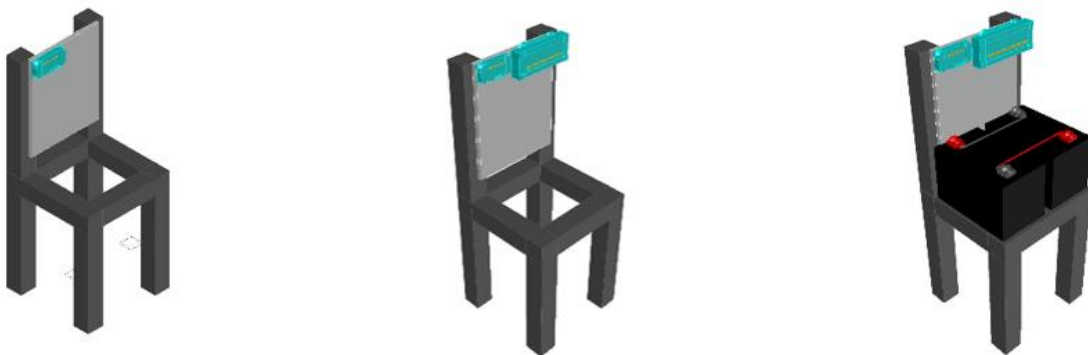
Figura 25.- Instalación del inversor, regulador y baterías
