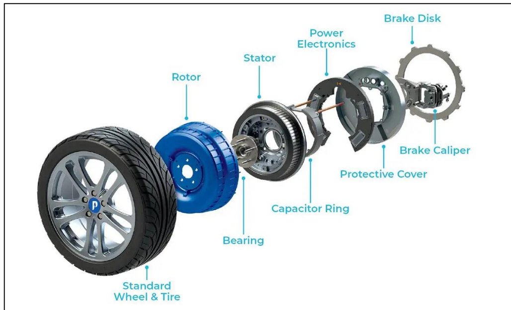
Figura 11 Tren de Impulsión directamente en cada una de las ruedas del Vehículo Eléctrico
