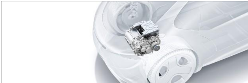
Figura 10 Tren de Impulsión el cual reemplaza el Motor Térmico, por un Motor Eléctrico
