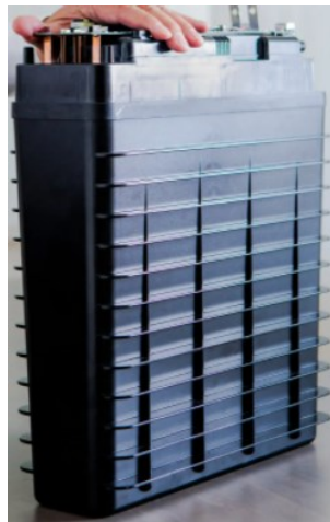
Figura 1.9. Batería zinc aire
