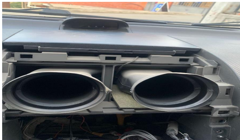
Figura 41: Desmontaje del Tablero Fuente: Elaboración Propia.
