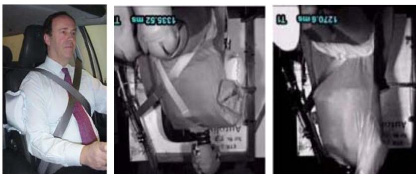
*Figura 11: Imagen del cinturón "X" y de una prueba de vuelco con un cinturón "X" y otro con un cinturón de tres puntos convencional.*
