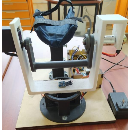
Figura 38. Vista Frontal del rehabilitador construido.
