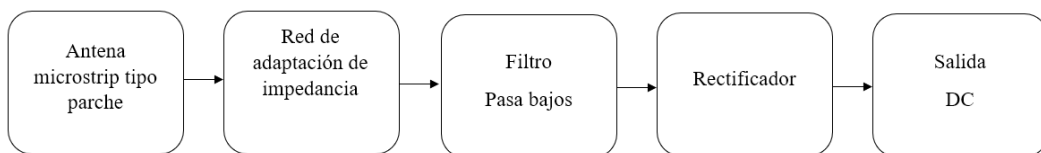
Fig. 1. Diagrama de bloques de la transferencia de energía inalámbrica conformado por la antena tipo parche (capta la energía electromagnética), el acople inductivo, el filtro pasa bajos, el rectificador y la salida DC.
