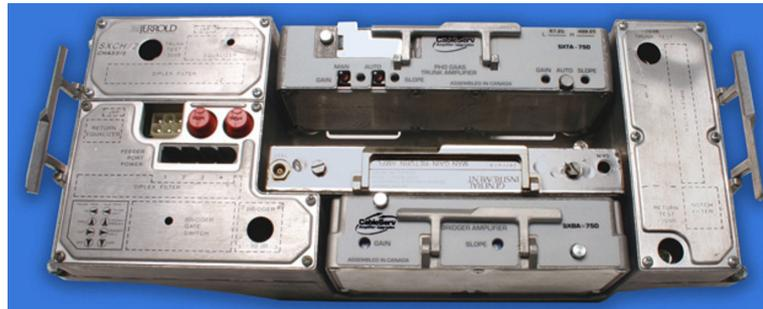
Figura 3.25. Amplificador GI SX Trunk Station<sup>[1]</sup>
