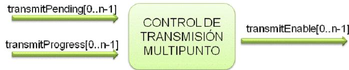
Figura 1.20. Interfaces del Servicio de Control de Transmisión Multipunto <sup>[1]</sup>
