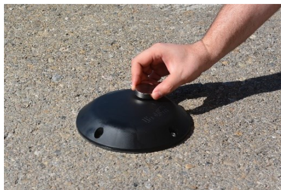
Figura 3.6 Proceso de arranque magnético del nodo Smart parking.
