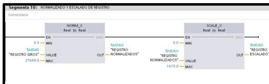
Fig. 173 Función Norm y Scale.
