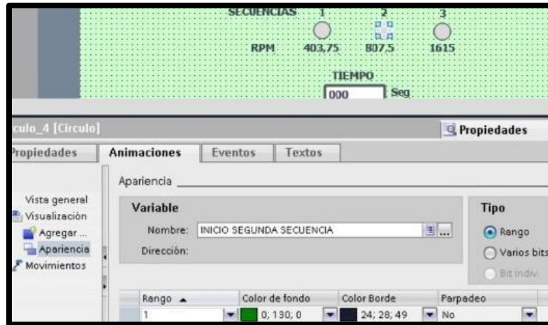
Fig. 184 Configuración de la secuencia 2.
