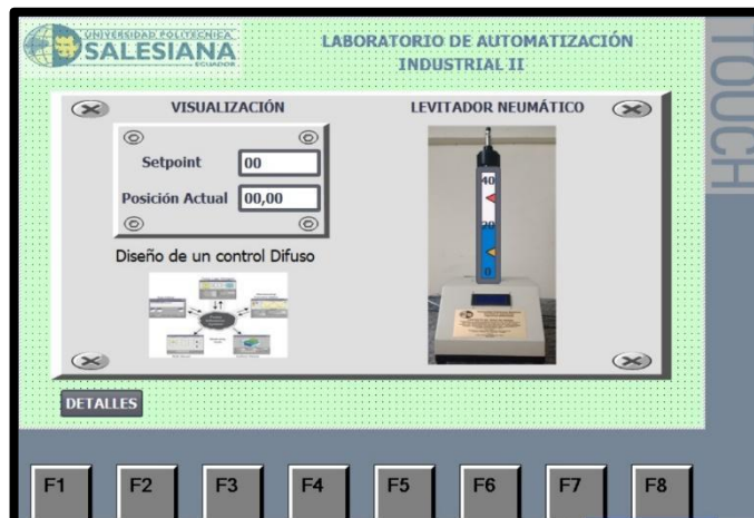
Fig. 253 Programación de la Pantalla de Visualización
