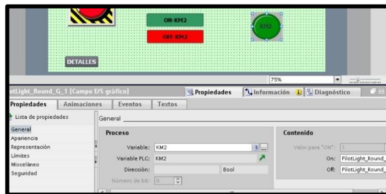
Fig. 83 Configuración de luz piloto KM2.
