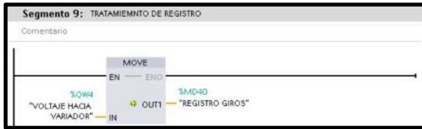
Fig. 172 Tratamiento de registro 2
