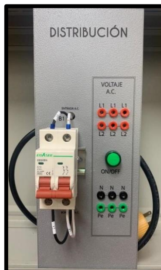
Fig. 32 Lámina de Distribución de Poder
