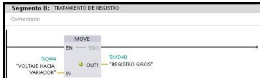
Fig. 171 Tratamiento de registro 1
