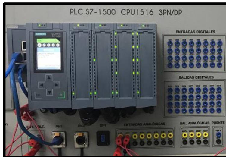
Fig. 7 Configuración de un sistema S7-1500
