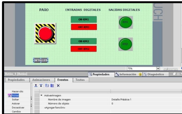
Fig. 84 Configuración del botón Detalles.
