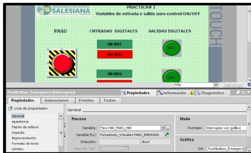
Fig. 77 Configuración del Paro de Emergencia.
