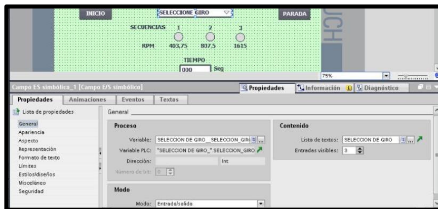
Fig. 178 Configuración del selector de giro del motor.
