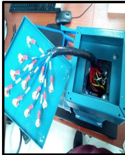
Fig. 36 Caja de conexiones para motor ½ Hp.
