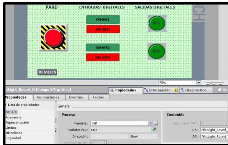
Fig. 82 Configuración de luz piloto KM1.
