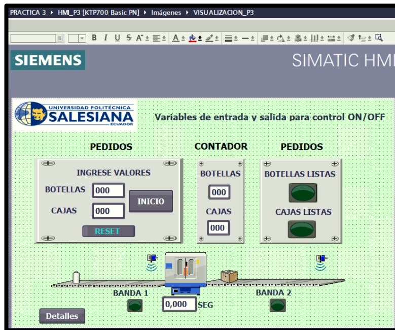
Fig. 125 Programación Pantalla de visualización.
