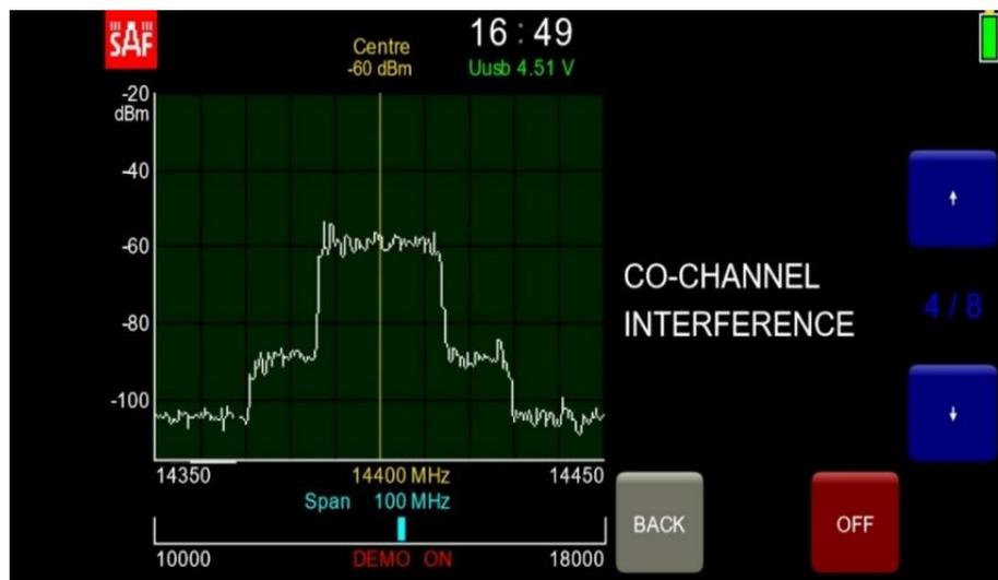
Figura 2.13: Interferencia cocanal
