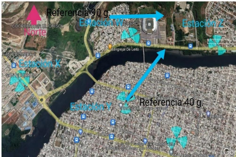
**Figura 10.17:** Azimut de señal interferente
