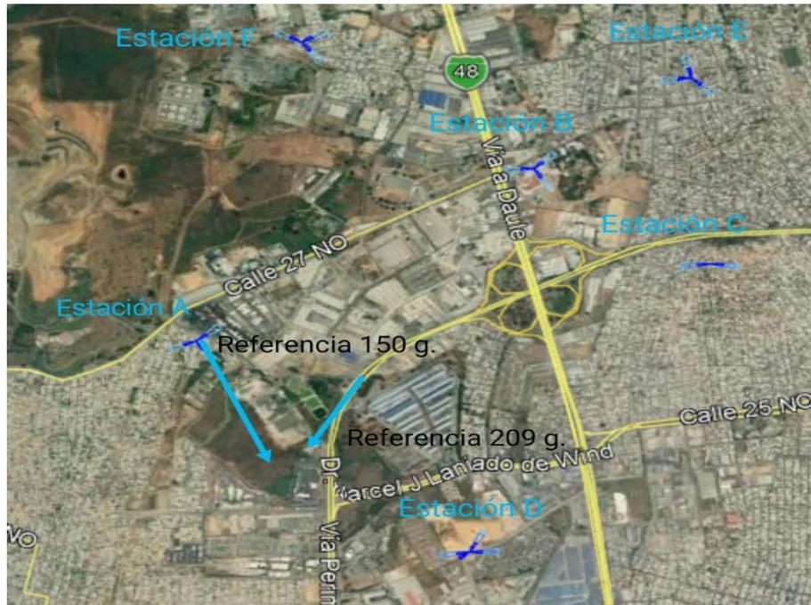
**Figura 9.18:** Azimut de referencia desde punto adyacente.
