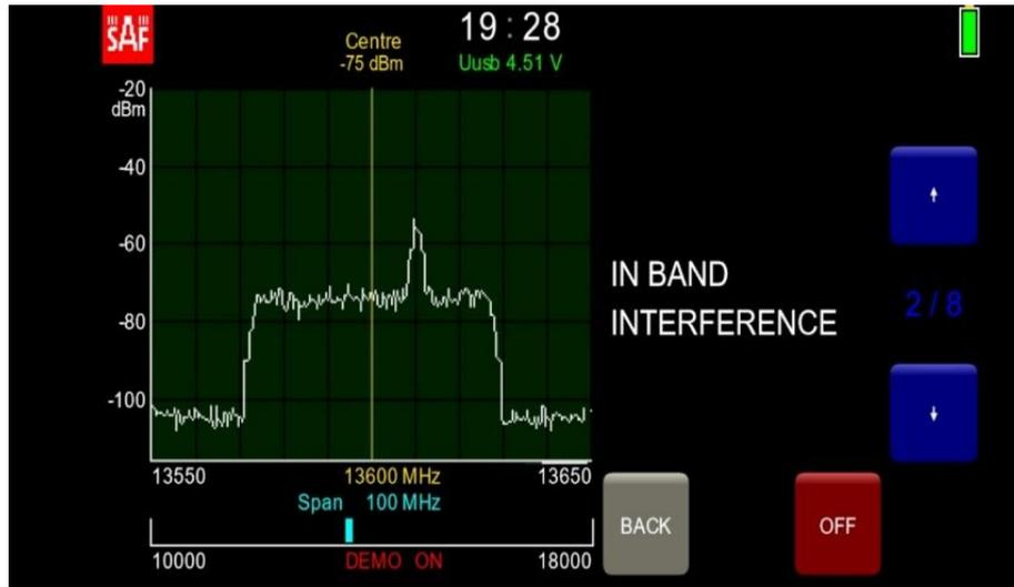
**Figura 2.15:** Interferencia dentro de banda
