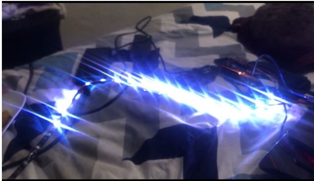
Figura 41: Primeras pruebas de control comandando una tira de LEDS RGB con integrado WS2811
