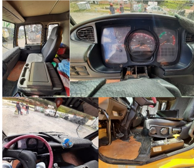
Figura 36: Vista del Interior de la Cabina y Mandos Volqueta Nissan PKC212EHLB
