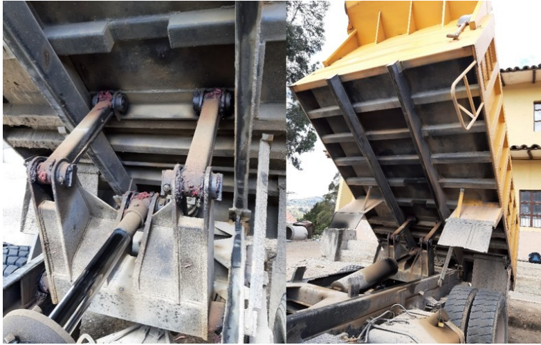
Figura 34: Balde y Sistema Hidráulico de Tolva Volqueta Nissan PKC212EHLB
