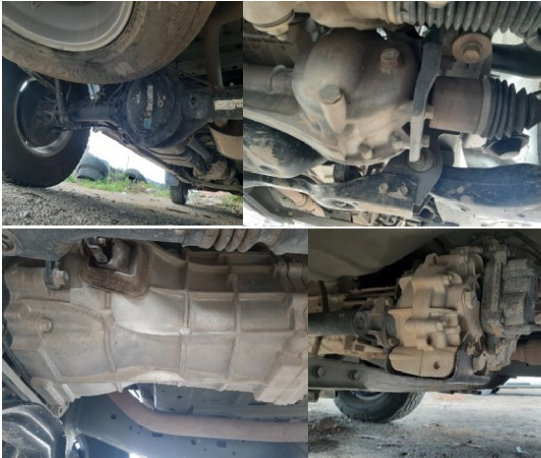
Figura 27: Vista de la Caja y Diferencial Chevrolet DMAX CRDI 3.0 CD 4X4 TM
