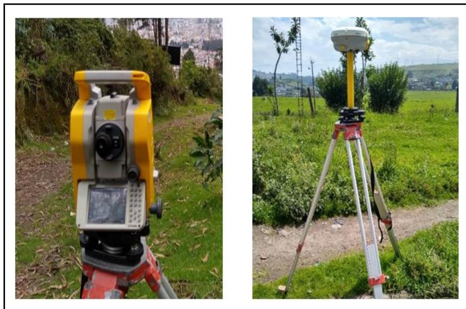
*Nota:* Se muestra aparatos utilizados para el levantamiento topográfico de la zona de captación y aducción
