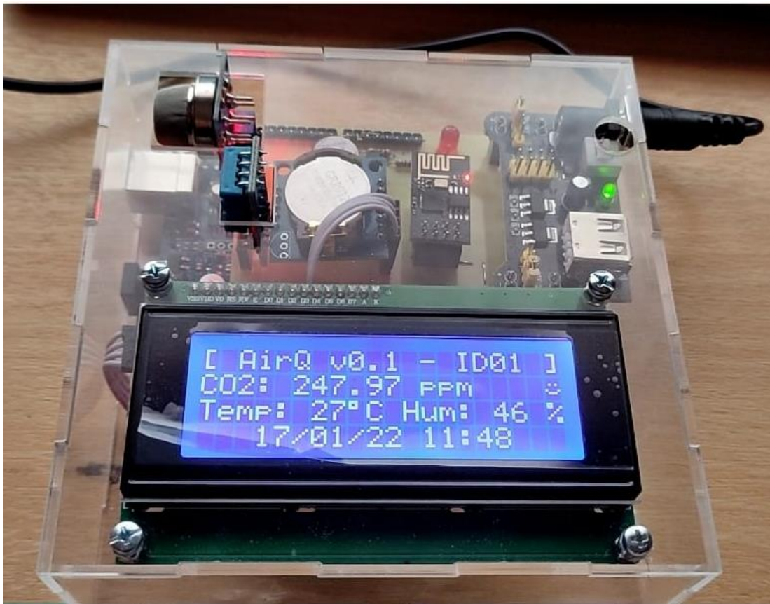
Dispositivo IoT para la medición de niveles de CO 2 implementado físicamente, Autores: Andrea López, David Medina
