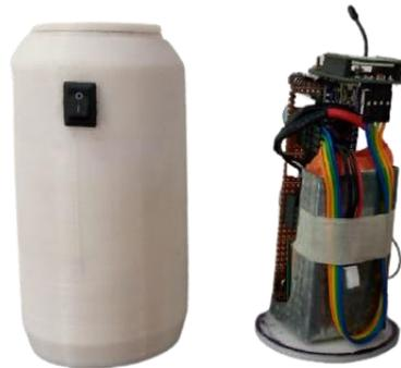
**Figura 11.** Fotografía del armazón con los componentes electrónicos
