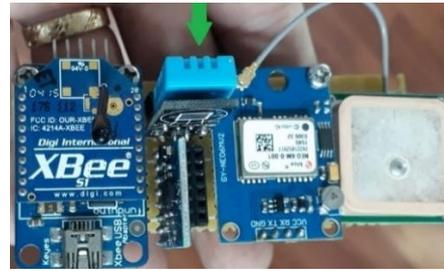
**Figura 4.** Fotografía del sensor DHT11
