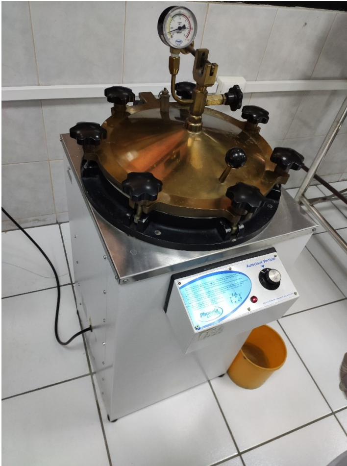
Imagen 3. Uso de autoclave para esterilización del Agar Mueller Hinton y tubos de ensayo para la preparación del inóculo bacteriano
