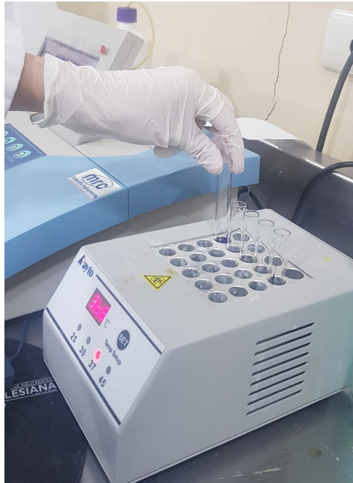
Foto 9. Incubadora de baño seco “Rayto”
