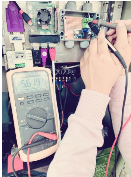
Resultado de energía en el módulo XL6009, Fuente: Bryan Ortega, Dayana Ortiz
