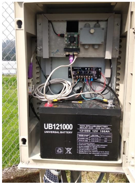
Primer gabinete con los equipos (raspberry,batería,controlador de carga,batería,convertidor RS 232,módulo transformador), Fuente: Bryan Ortega,Dayana Ortiz
