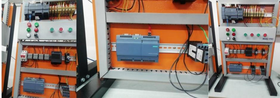
Figura 5.2: Implementación de IoT 2040 en laboratorio. Fuente: Elaboración propia
