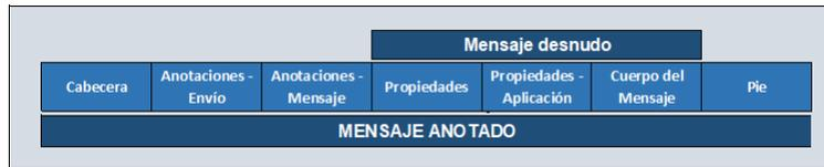
Figura 2.9: Estructura del mensaje - AMQP. Fuente: [Vinoski, 2006]
