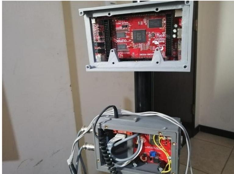
Figura 31 Vista frontal de las cajas protectoras del prototipo IoT Telemedicina.
