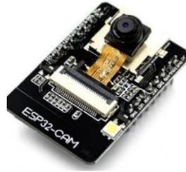
Figura 12 Cámara ESP32
