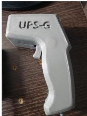
Figura 36 Sensor de temperatura con infrarrojo
