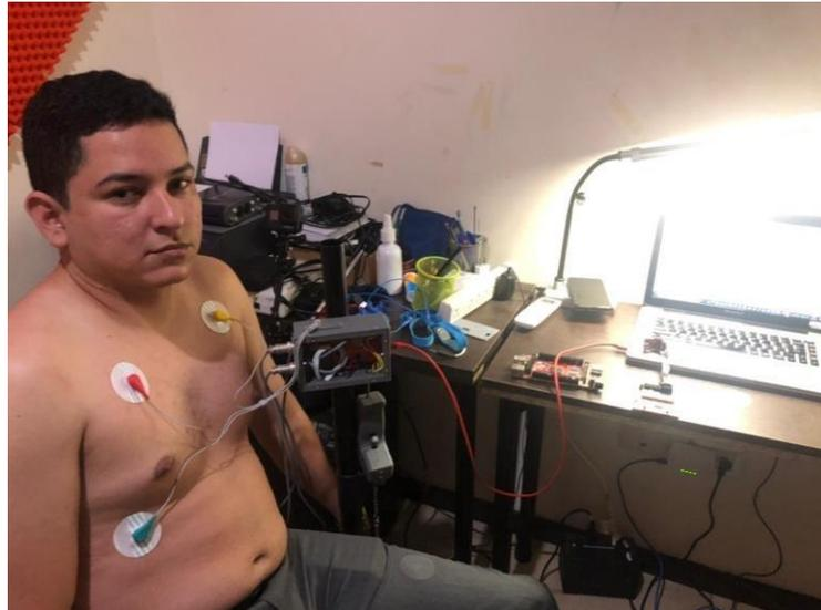
Figura 5: Colocación de electrodos
