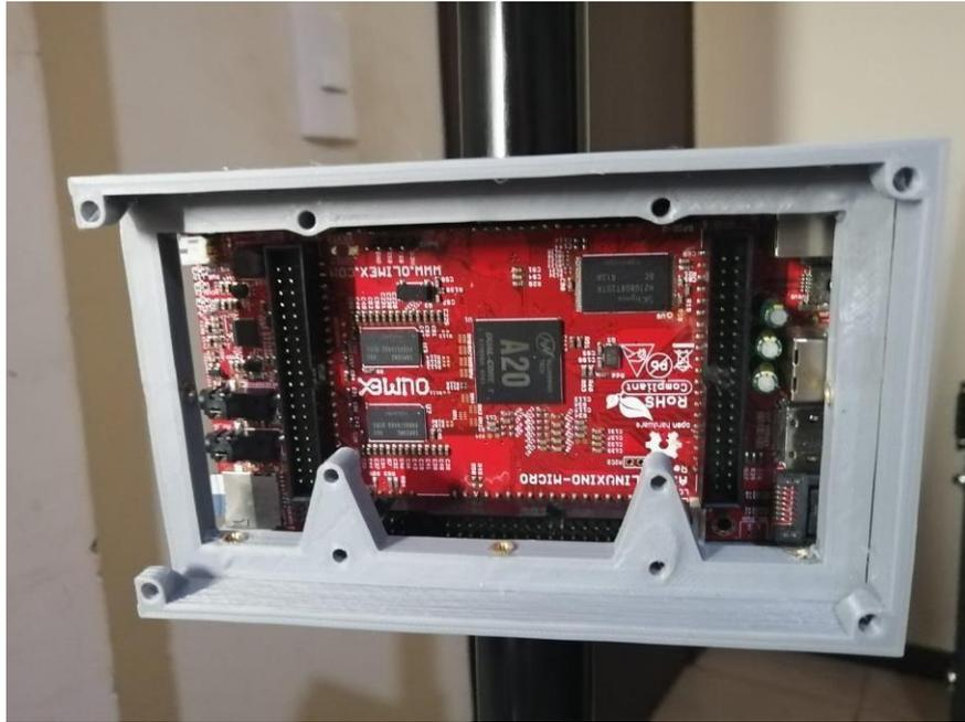
Figura 32 Carcaza de protección de la tarjeta A20 Olinuxino Micro
