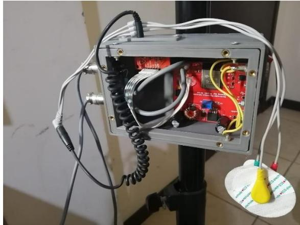
Figura 35 Conexión de electrodos en ECG
