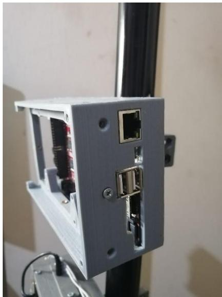
Figura 33 Vista lateral de conexión de periféricos de A20 Olinuxino Micro.
