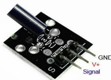
Figura 23. Estructura física del sensor de vibración KY002
