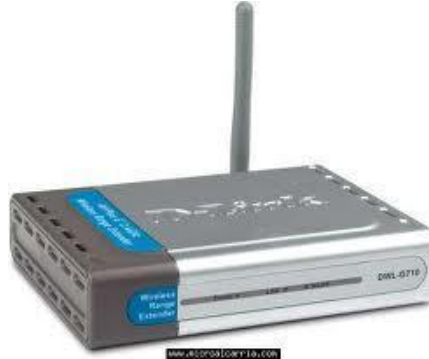
Figura 2.11 Repetidor Fuente: (Ecured.cu, 2021c)
