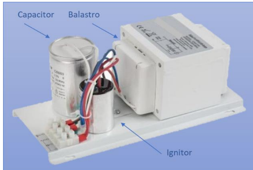
Figura 3- Conjunto eléctrico de la luminaria HPS. Fuente: [autor]
