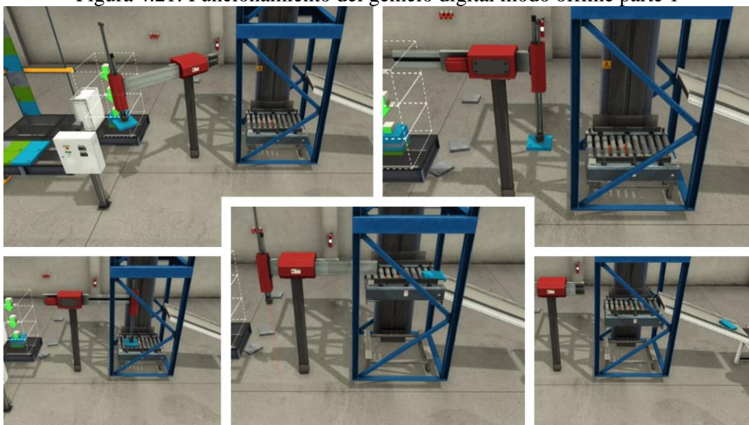
Figura 4.21: Funcionamiento del gemelo digital modo offline parte 1
