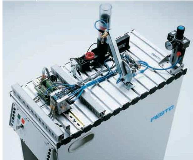
Figura 2.2: Estación de distribución
