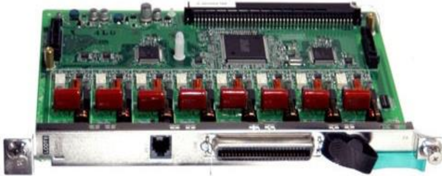
Figura 3.7 Tarjeta telefónica LCOT8 para enlace troncal de 8 puertos
