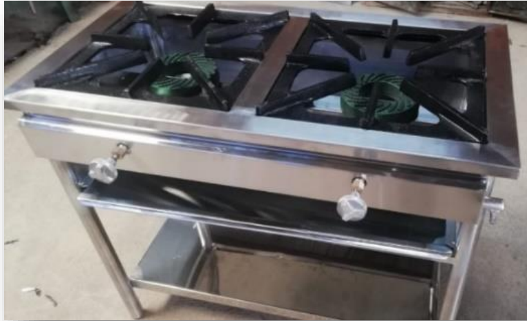
Figura 9. Cocina industrial a GLP, Autores
