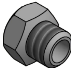
Figura 37: Shiglor para cocina industrial (Diseño para planos), Autores.
