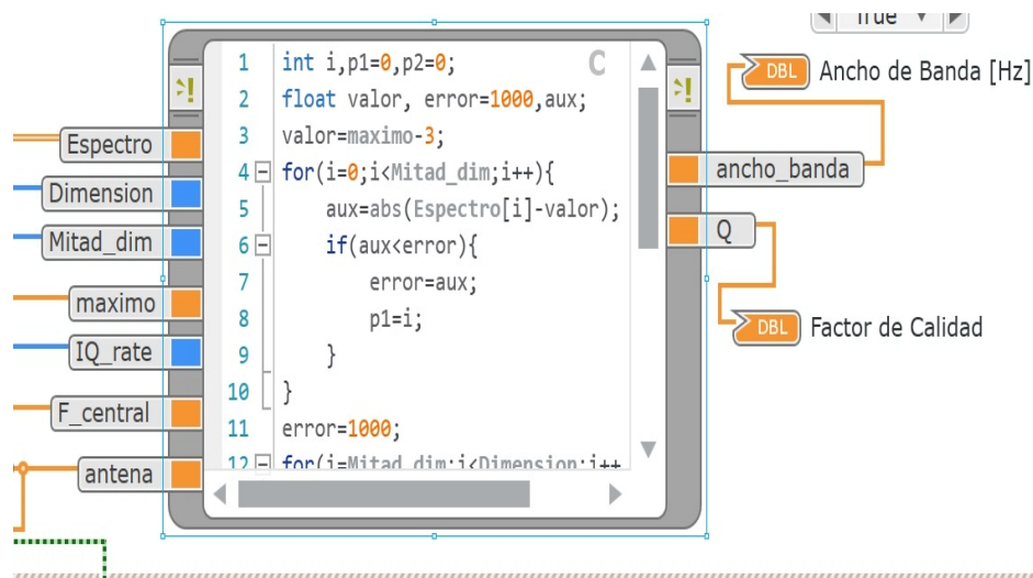
Codificación de un bucle en C ++ utilizando las fórmulas de Ancho de haz, Directividad, Eficiencia, Factor de calidad, Ganancia y Ancho de banda. Fuente: Iza Juan, Toapanta Kevin
