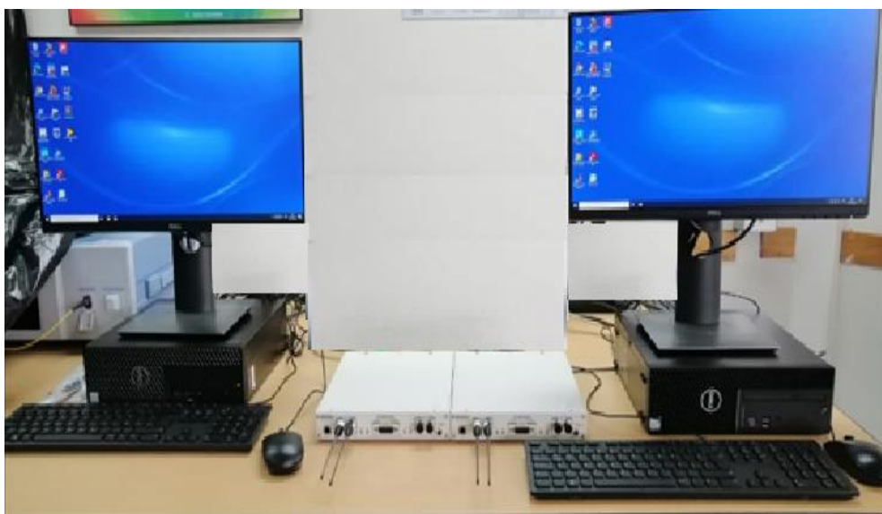
Figura 3.8 Interconexión de los USRP con las computadoras
