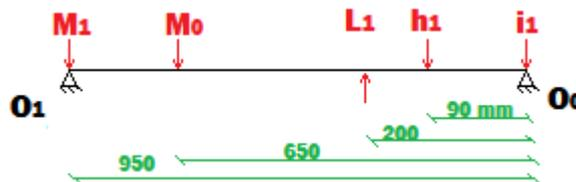
**Figura 48** Diagrama de cuerpo libre aplicado en la viga O.
