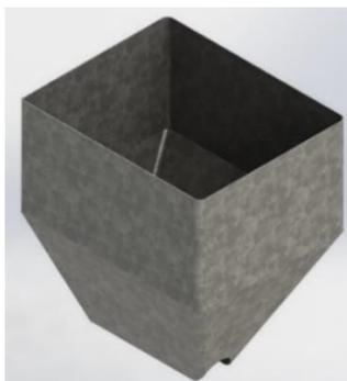
**Figura 17** Modelo de tolva realizado en el programa SolidWorks.
