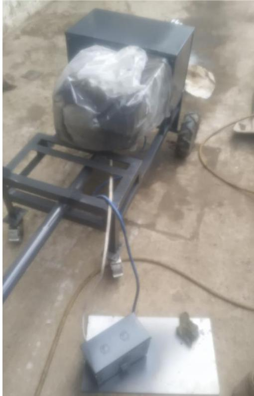
**Anexo 4:** Estructura aplicada capa anticorrosiva en fase de ensamble.
