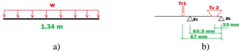
**Figura 44** Diagrama de cuerpo libre a) Peso del tornillo cargado, b) Cargas sobre cámara del tornillo.
