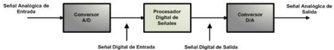
Figura 1.2: Diagrama de bloques de un sistema digital de procesamiento de señales.
