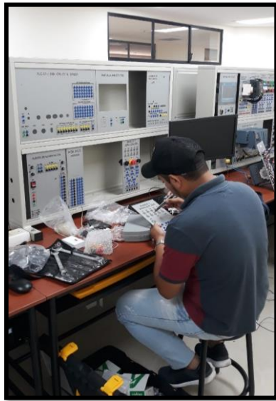
Figura 3. 11 Tesista ubicando borneras y arreglando perforaciones.
