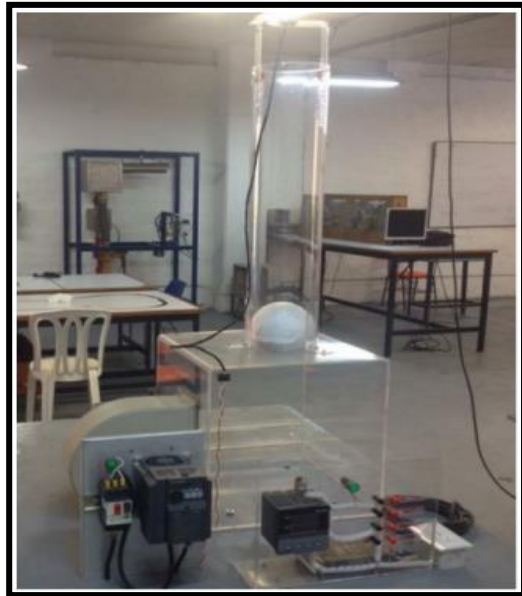
Figura 2.18 Maqueta de un proyecto de levitación neumática
