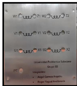
Figura 3. 3 Placa perforada con ubicación en las bobinas
