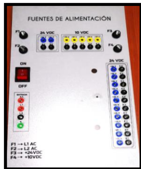
Figura 3. 6 Placa con borneras para fuente de alimentación
