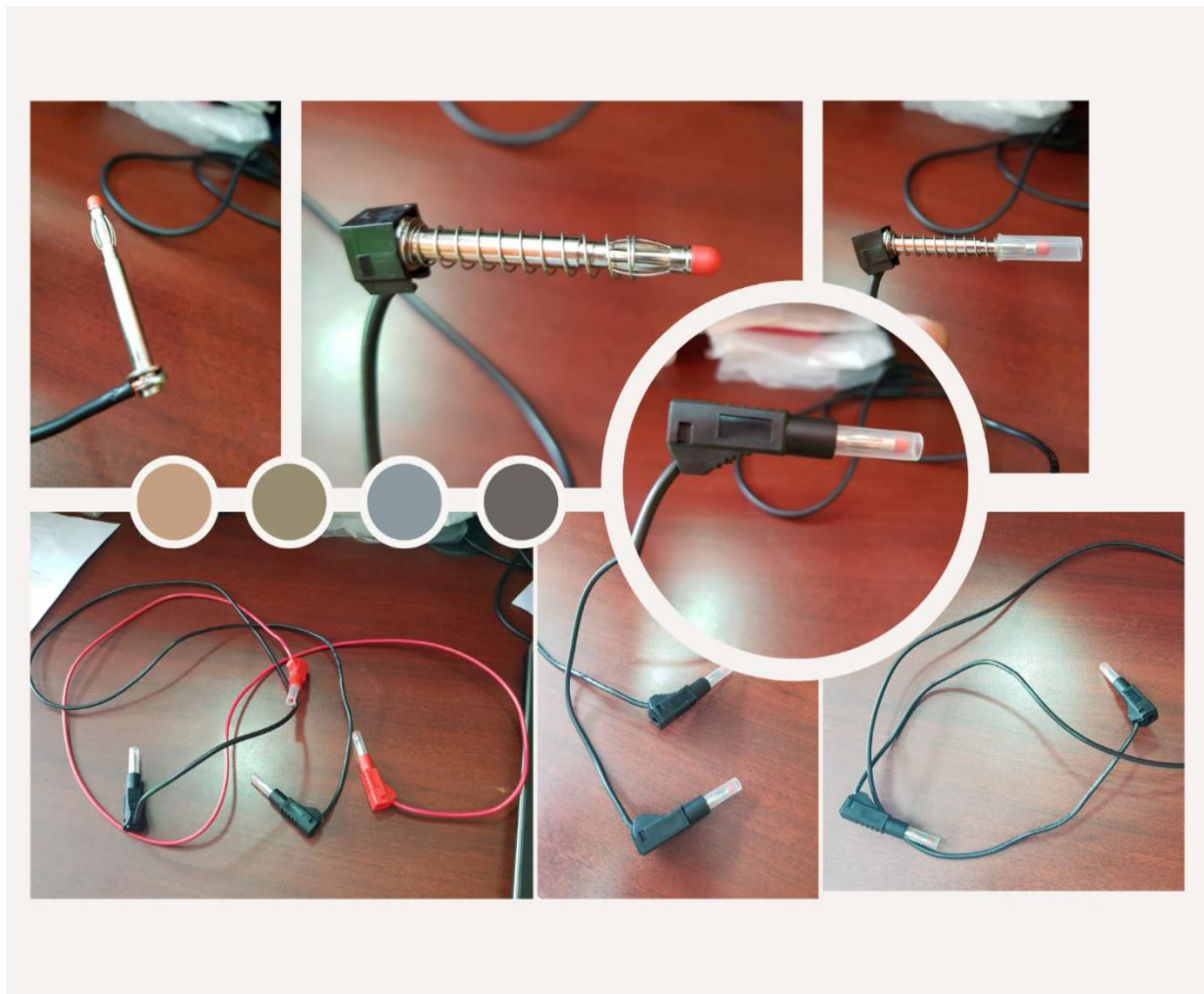
Figura 26 Ilustración gráfica de la elaboración de los terminales de prueba tipo banana. Elaborado por: El Autor
