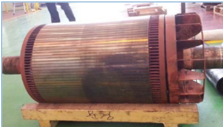
Figura 6: Rozamiento estator-rotor en motor de 6,6 kV y 800 kW con excentricidad.
