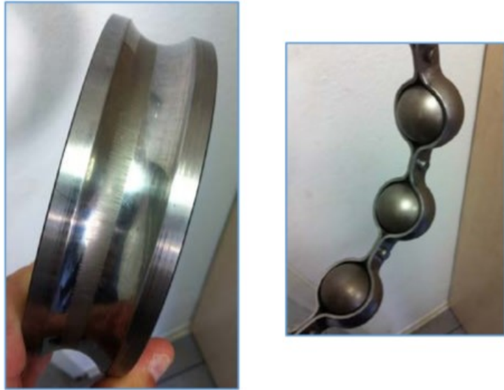
Figura 5: Aspecto de pista (izquierda) y bolas (derecha) en un rodamiento afectado por el paso de corrientes.
