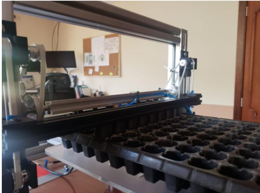
**Figura 30:** Modelo mecánico de la propuesta (Dispositivo de siembra).
