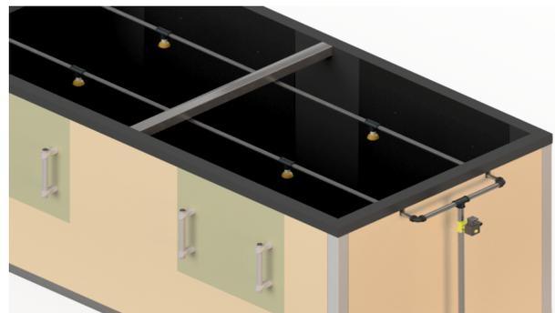
**Figura 29:** Diseño de la cámara aeropónica (acercamiento)
