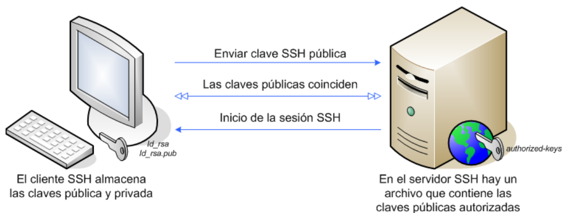
Figura 11. Gráfico explicativo sobre el funcionamiento del protocolo SSH, tomado de sitio web https://pressroom.hostalia.com
