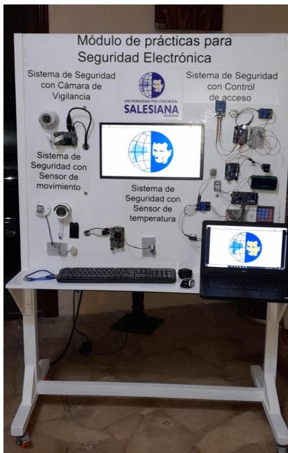
Figura 59. Módulo didáctico de prácticas de seguridad electrónica. Elaborado por autores.
