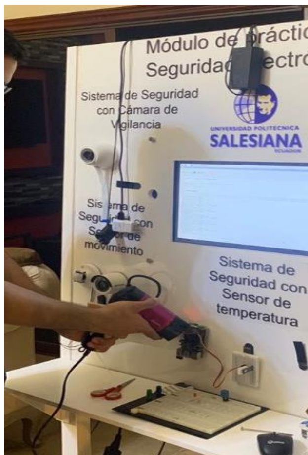
Figura 18. Disparo de calor al sensor DHT22.
