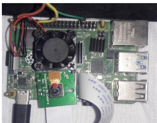
Figura 40. Conexión física de CámaraOV5647 y Raspberry Pi. Elaborado por autores.
